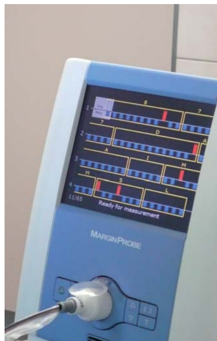
Abb. 2: Binäres Signal auf dem Display
